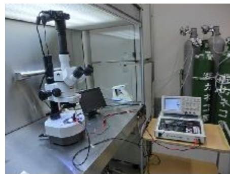
図 1. 本研究で用いられた遺伝子導入システム。NEPA21 エレクトロポレーター並びにバスタブ電極、実体顕微鏡より構成される。
