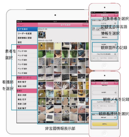
図3 システム概要。携帯端末は情報収集および閲覧が可能であり、タブレットは閲覧が可能となっている。
