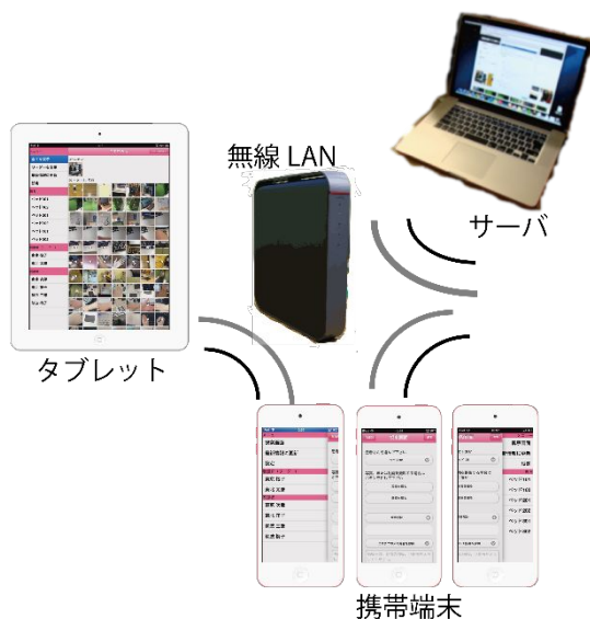
図3 システム概要。携帯端末は情報収集および閲覧が可能であり、タブレットは閲覧が可能となっている。
