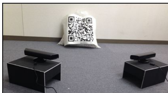
図 6 本研究で開発した 2 台の kinect を用いて 3 次元形状を計測するシステム
