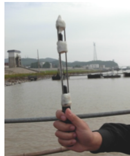
図1. 使用した音響記録計。小型鯨類の発する超音波(エコーロケーション音)をイベントとして記録する
