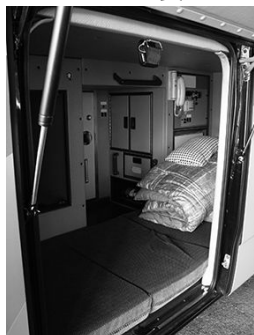
図1 バス中央底面の荷台を改造した仮眠室の例
