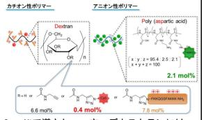
2 mol%で導入し、一方、デキストランには、 がんで亢進しているプロテインキナーゼ Cα(PKCα)に対する基質と Cy5 をクリック反 応により導入した。Cy5 については、ナノ粒 子形成前後で蛍光強度に変化が生じないよ うに。4 mol%導入し、これを内部標準蛍光と して用いて ratiometry を可能とした。双方 のポリマーを 1:1 で混合すると、100 nm 程度 の均一な粒径を有するナノ粒子が形成され、 TAMRA の蛍光は効率よく消光されたが、Cy5 の蛍光強度はナノ粒子形成前後で変化なく 一定であった。そこで、種々の濃度の PKClphaによりリン酸化した後の蛍光変化を両者の 蛍光強度比でプロットしたところ、下図左の ように良好な応答を示した。また、PKCαの 阻害剤である Go6983 の IC50 値を評価したと ころ、16 nM という値が得られ、報告された 値と良い一致を示した。
