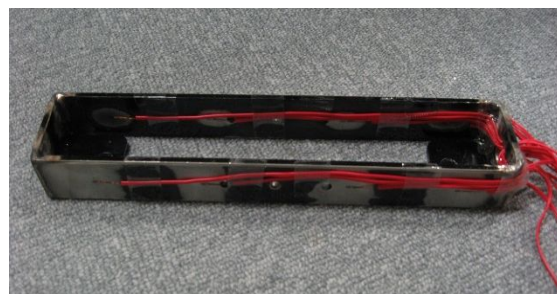
図 3 脇当ておよびひずみゲージの貼り付け
