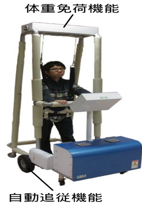
図1 構築した全方向移動型免荷式歩行訓練支援ロボット
