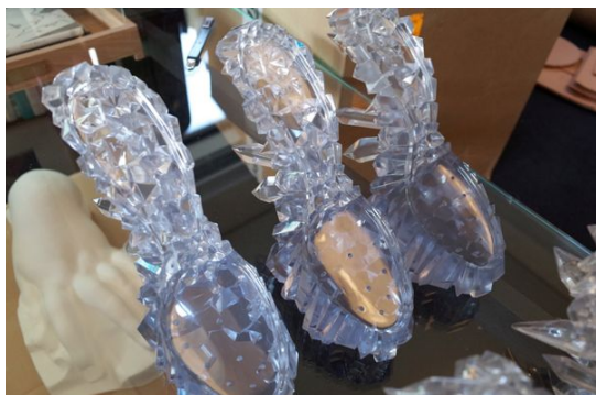
3D データ制作し 3D プリント行ったソール形状
