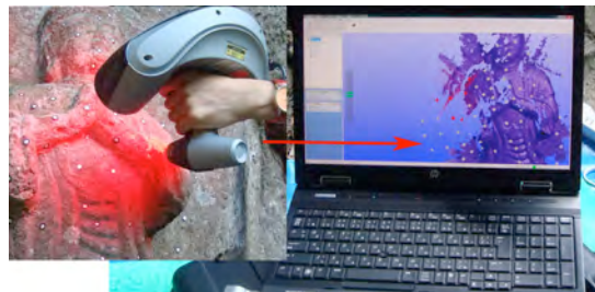
図3《三次元ポータブルスキャナによる計測》
