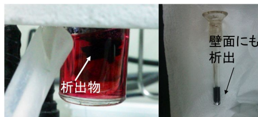
図 6 : (a) [EMIM][TfSA]IL 中に析出した PEN 結晶、(b) 石英管壁に析出した PEN。IL 中での析出では、高濃度に溶解した PEN で、赤ワイン色に着色する。
