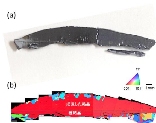
図 5 : Si 基板からエピタキシャル成長させた(a)サンプルの写真と(b)方位解析画像結果
