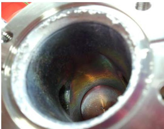
図4 ドリフト管のナイフエッジ付近に白色の ZnO 粉末が付着している上、内壁に虹色の縞模様が付いている。
