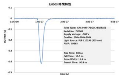
図8. 感光性結晶化ガラスを用いた細孔型MPGDとバイアルカリ光電面からなるガス光電子増倍管の時間特性。
