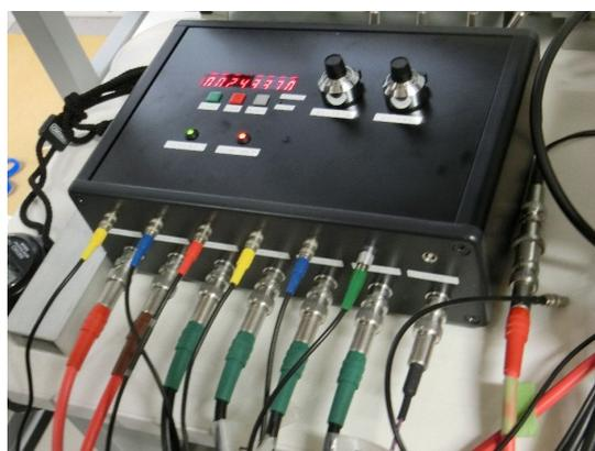
この計測器は1個のAC100Vコンセントで全ての電源を供給する。パネルにはスタート(緑)ストップ(赤)リセット(灰)の3個のボタンがあるだけで、緑と赤を同時に押すと2系統(ファイバーシンチレーターの2本 +  $\mu$  粒子除去用シンチレーターの1本、波長変換ファイバーシートの4本)の光電子増倍管の電圧設定モードと計測モードの切り替えができる。電圧設定モードでは緑と灰を同時に押すと光電子増倍管の印加電圧が 0V 事前に設定してあった電圧に切り替わる。設定電圧は右側の2個のつまみで調節できる。計測モードではスタート、ストップ、リセットのボタンだけで計数し、計数値はパネルに表示される。このように、操作は非常に簡単である。
