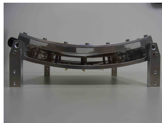
図6 湾曲GEM試作機(側面写真)
