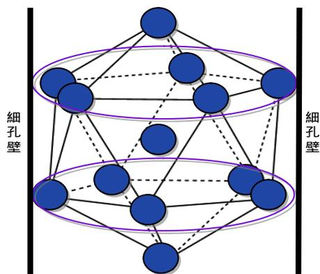
図 11 正二十面体構造
