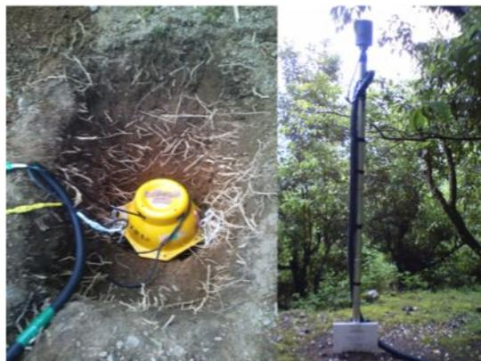
図 2. 馬路基準点におけるフラックスゲート型ベクトル変化計 (左) とプロトン全磁力絶対計 (右) の設置状況。
