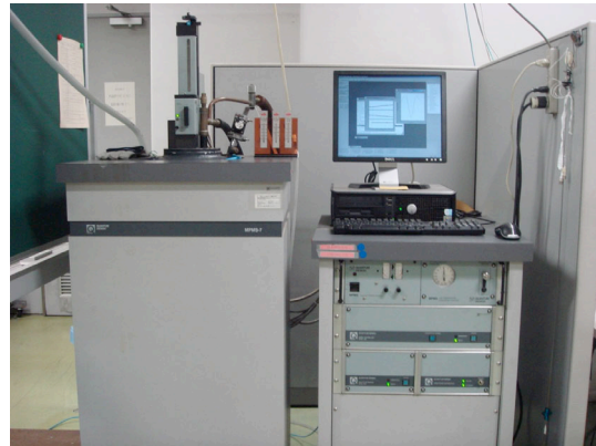
図 2. SQUID 磁束計: MPMS-7
