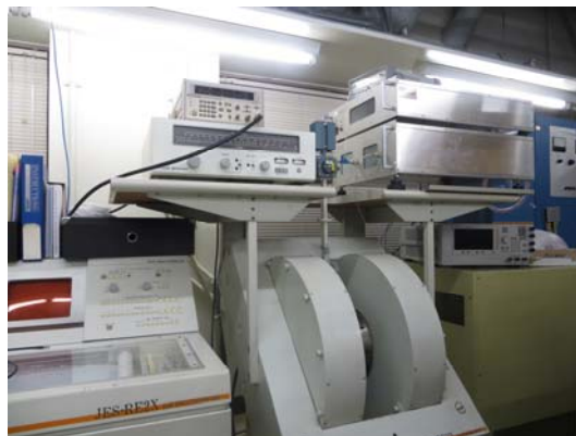
図1 14 MHz帯 in-situ DNP-NMR装置全体図
