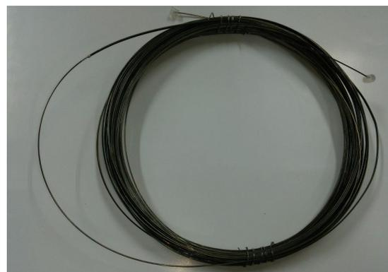
図1 試作した平型中空金属カラム
