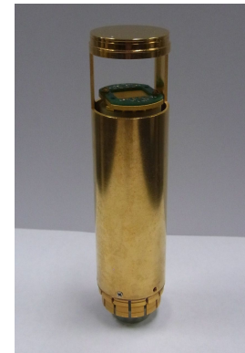
図 1: 本研究で製作した断熱消磁冷凍機
