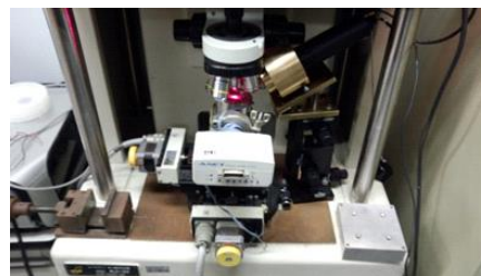
図 5 光放射圧の測定装置
