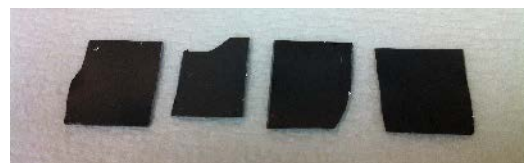
図 3 自然酸化膜付 Si(100)基板上に堆積させた SiC 膜の写真。左から堆積温度 760°C、800°C、850°C、900°Cである。
