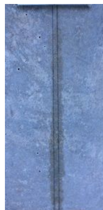
写真2 流水ガイドとしてテグスを用いた場合
