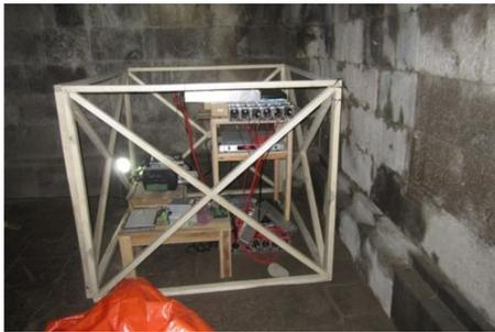
写真2 祠堂内に設置したミュオン観測機器
