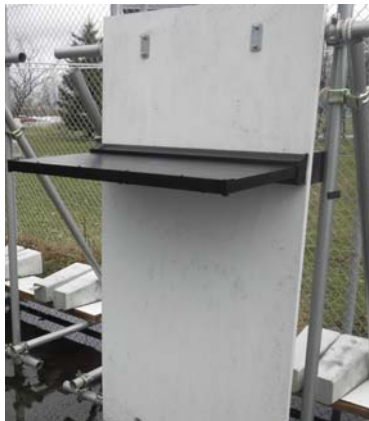
写真2 底の融雪を促進する仕様 (壁面：高反射仕上、底：低反射仕上)
