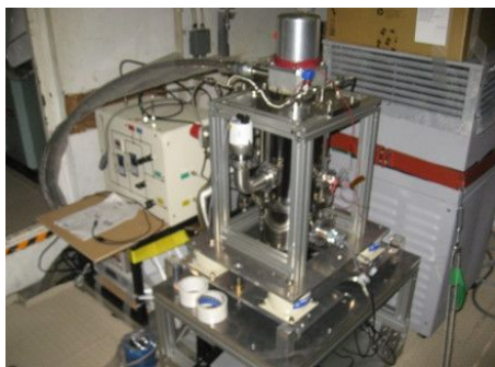
図1 冷却システム熱負荷応答計測装置
