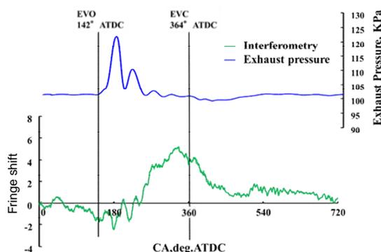
図 9 排気管内圧力履歴および干渉縞移動量
