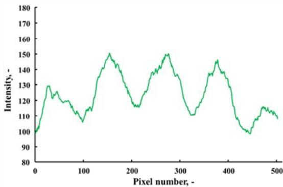
図 3 干渉縞強度分布（512 ピクセル，移動平均後）
