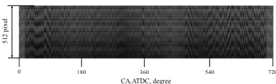
図 8 干渉縞のクランク角に対する移動の様子
