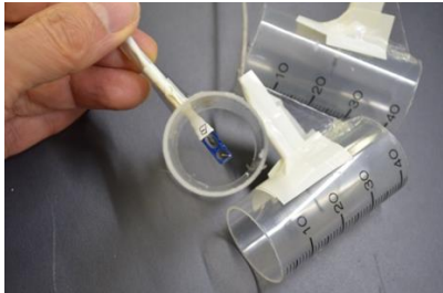
図2 米国製単方向型風速計を樹脂製円筒内に組み込んだ様子
