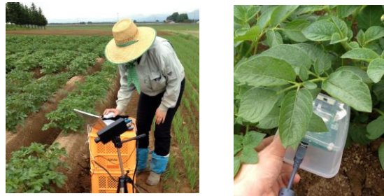
図3 ハイパースペクトルカメラ (左図) と MEMS センサ (右図) によるスペクトラムデータの同時測定
