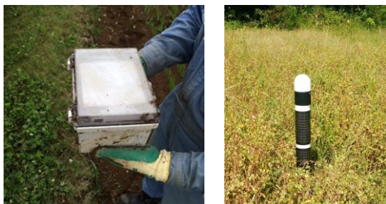
(a)故障した測器 (b)光センサを内蔵 図10 故障した測器及び多波長光センサを内蔵したフィールドサーバ試作機
