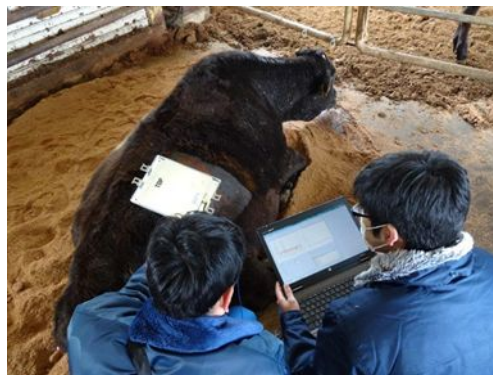
図3．インプラントしたバッテリーレス温度センサーのデータを，レシーバーを用いて体外から採取する様子
