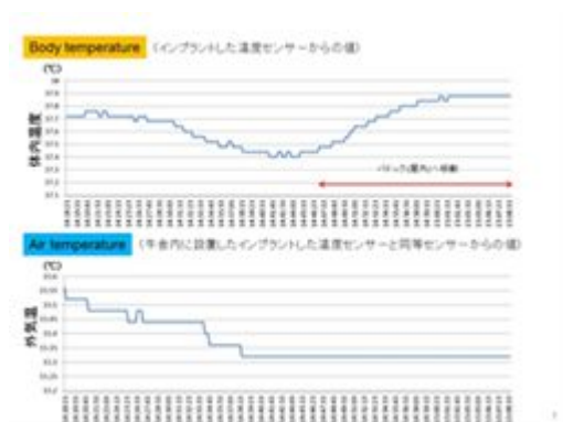
図7．温度センサーをインプラントした実験牛からワイヤレスでPC上に体温情報を受信したデータ(上段)と牛舎内に置いた同じセンサーのリアルタイムの温度変化(下段)
