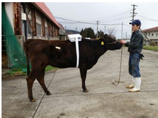
図5．バッテリー付温度センサーをインプラントし、その受信機とレシーバーとバッテリーを背負わせた実験牛の様子
