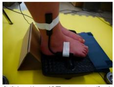
角度センサーの設置:シーソーボードを水平にし、角度0度を設定し、最大背屈30度、最大底屈30度になるようにキャリブレーションをした。
