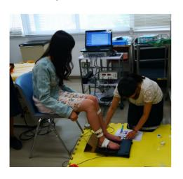
測定の様子:椅子に腰掛け膝を 90 度に設定し、左脚にプローブ、右脚に角度センサー、水平に保つ。
