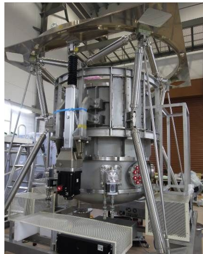
図 2 中間赤外線観測装置 MIMIZUKU の全景
