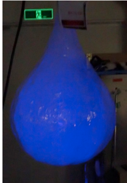
図1. \phi 80cmのテストバルーン。部屋を暗くした後、ブラックライトを照射した状態である。バルーンが青く光っていることが視覚的にわかる。
