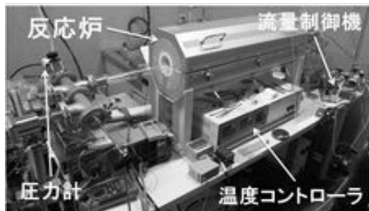
図 1. CVD 法による \text{NbS}_2 成長の概要
