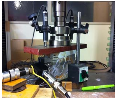
図2 ジャッキを挿入したモルタル供試体の圧縮載荷試験の様子
