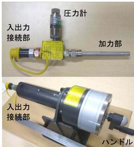
図1 開発したジャッキシステム
