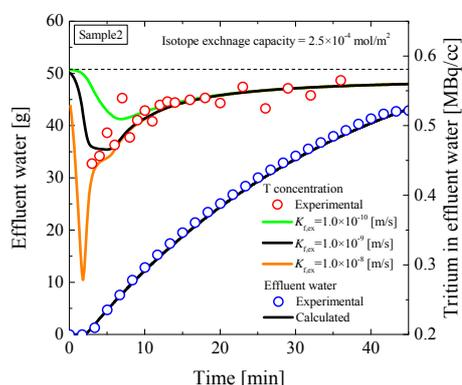
図 6 天然土壤充填層へのトリチウム水透水実験結果と計算結果の比較
