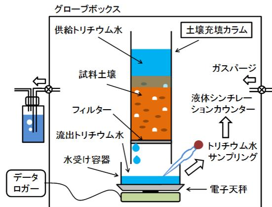
図 2 トリチウム水透水実験装置概略図
