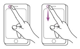
タッチパネル領域と画面外領域は隣接しているため、両者間で指をシームレスに動かすことができる.既存のモバイル端末にも、タッチパネル領域の端から中央方向へのスワイプ操作が可能なものが存在するが、画面外領域でのジェスチャ操作と組み合わせるとさらに操作の種類を増やすことができる.たとえば、画面外領域を押下し、そのままタッチパネル領域内にスワイプするという操作が可能になる.このような操作のことを、本研究ではタップイン操作と呼ぶ.
