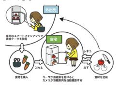
冷蔵庫内にはWEBカメラが設置されており、ユーザが冷蔵庫を開けると冷蔵庫内が自動で撮影され、その画像はサーバに保存される、外出先では、専用のスマートフォンアプリで画像が閲覧できる。アプリはサーバに保存された画像をユーザに提示する。
