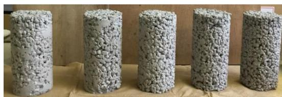
写真-1 POSSCの供試体(シリーズ1、左端から空隙率0.05、0.10、0.15、0.20、0.25)
