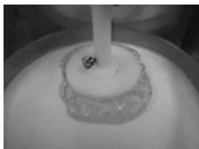
図. クリープメータ法による内部離水測定
