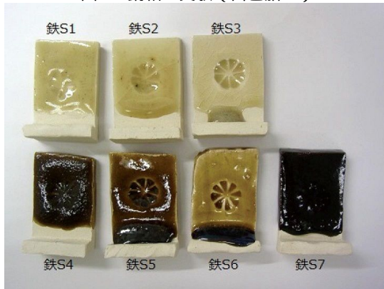
図2 鉄釉の実験（酸化焼成・白色胎土）
