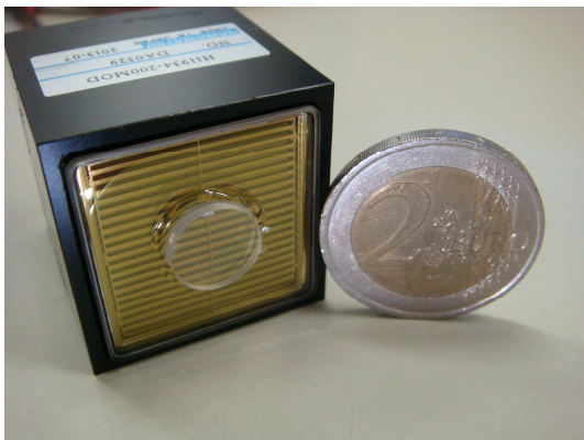
図2: Yb:Lu 2 O 3 シンチレータを用いた消滅ガンマ線用検出器の外観。
