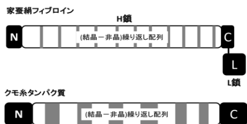
図2: 家蚕絹フィブロイン (上)、クモ糸タンパク質 (下) の一次構造模式図
