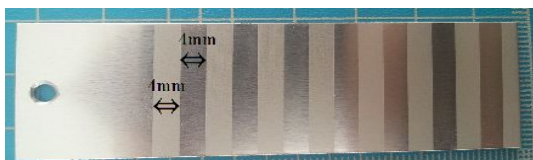
図 3 照射幅 4mm, 照射間隔 4mm の供試材
