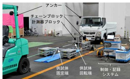
図2: 吊り紐の特性取得実験の様子
