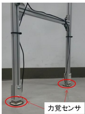
図4 歩行器にかかる力を計測する力覚センサ
