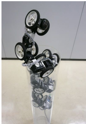
図1 配管内を移動するヘビ型ロボット
