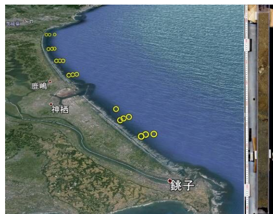
図-2 海底コア採取地点とコアの半割写真の一例(南海浜水深 19 m 地点)
