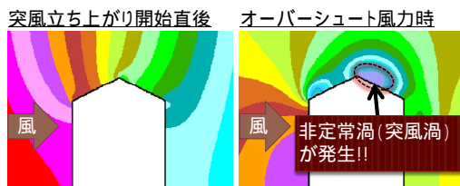
図2 突風時の物体周りの圧力コンター図
